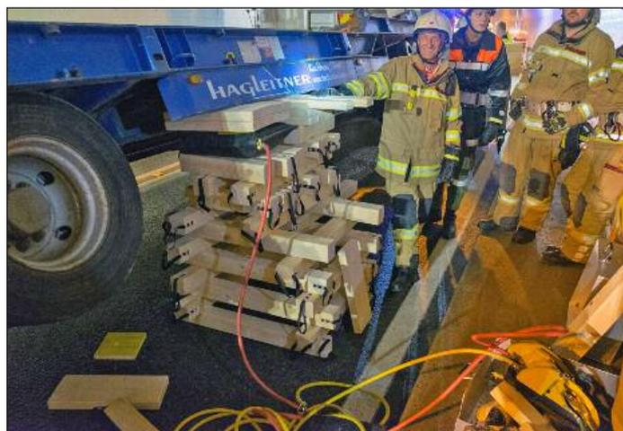
**Angehobener Tieflader um den darunter eingeklemmten PKW befreien zu können.**
