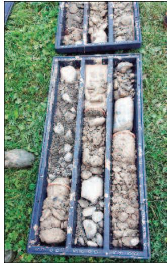
**Ein Bohrkern vom Achenberg bei der Grundwasser-Erkundigung**
