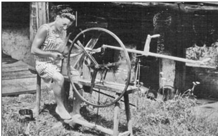
**Moidi beim Dengeln einer Sense an der von ihrem Vater selbst entwickelten Dengelmaschine**
